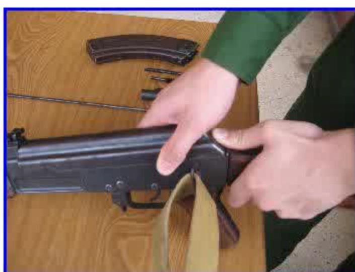
Hình 4-24. Tháo nắp hộp khoá nòng.
