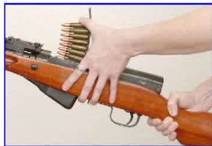
Hình 4-46. Lắp kẹp đạn vào súng
